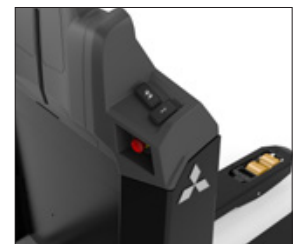
Mitgänger Bedienhebel in Rückenlehne und Mitgängerschalter und Schalter für Heben/Absenken.
